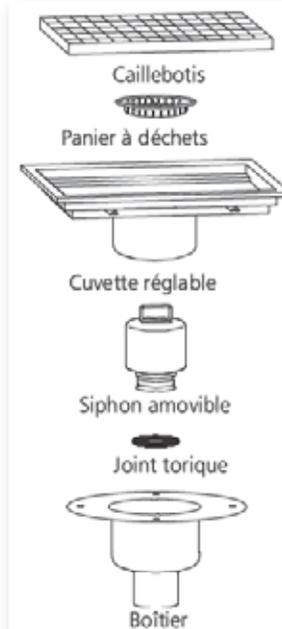
Caniveaux avec cuvette réglable
