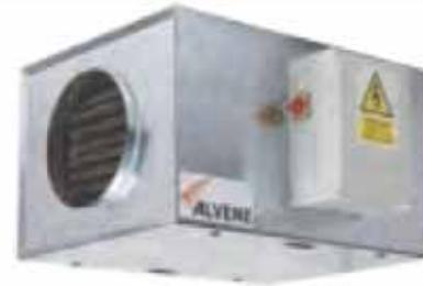
Caisson de traitement d'air avec batterie électrique autorégulée. Constitué de panneaux autoporteurs en acier galvanisé, avec isolation double paroi (ép. 25mm). Caisson à poser en faux-plafond. Accès sous le caisson par une trappe muni de poignées et de vis quart de tour.
